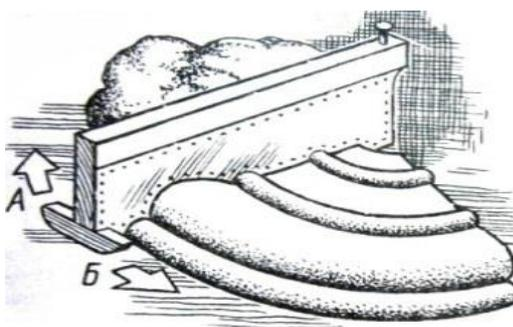
Перед тем как начать вытягивание простой архитектурную розетку, верстак, ползок шаблона и сам шаблон покрывают смазкой, которая облегчает движение шаблона.
